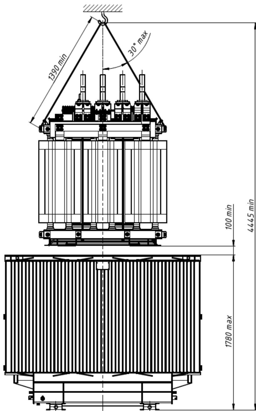
Рисунок А.26 – Эскиз подъема активной части трансформатора мощностью 2500 кВА
