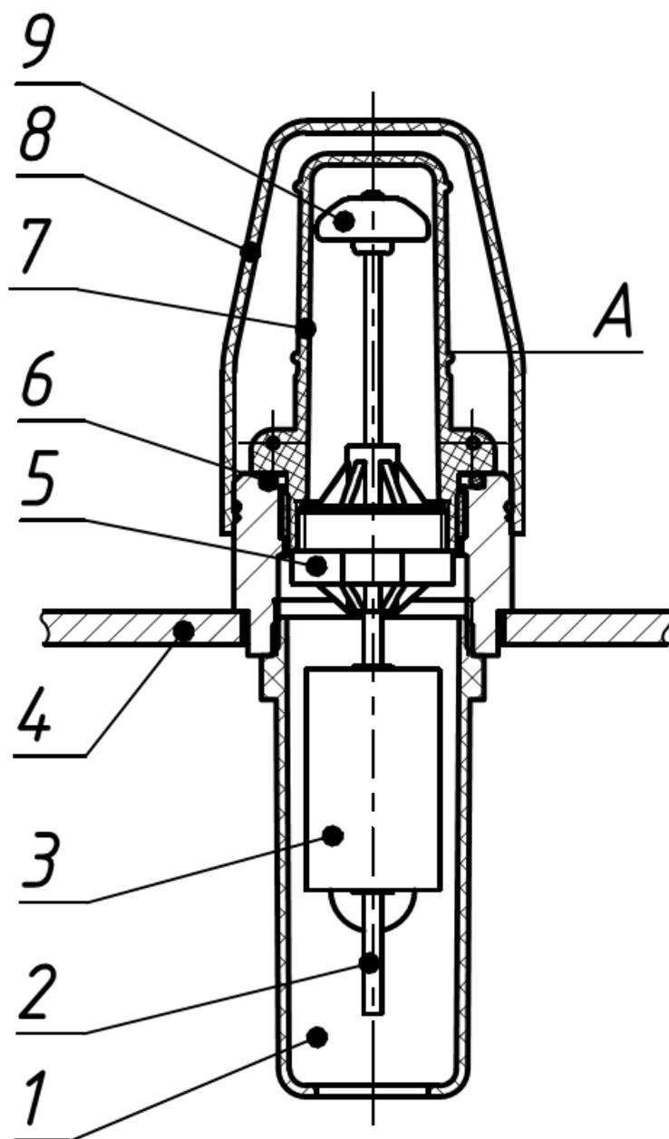
1 - стакан; 2 - шток; 3 - поплавок; 4 - крышка трансформатора; 5 - втулка;
