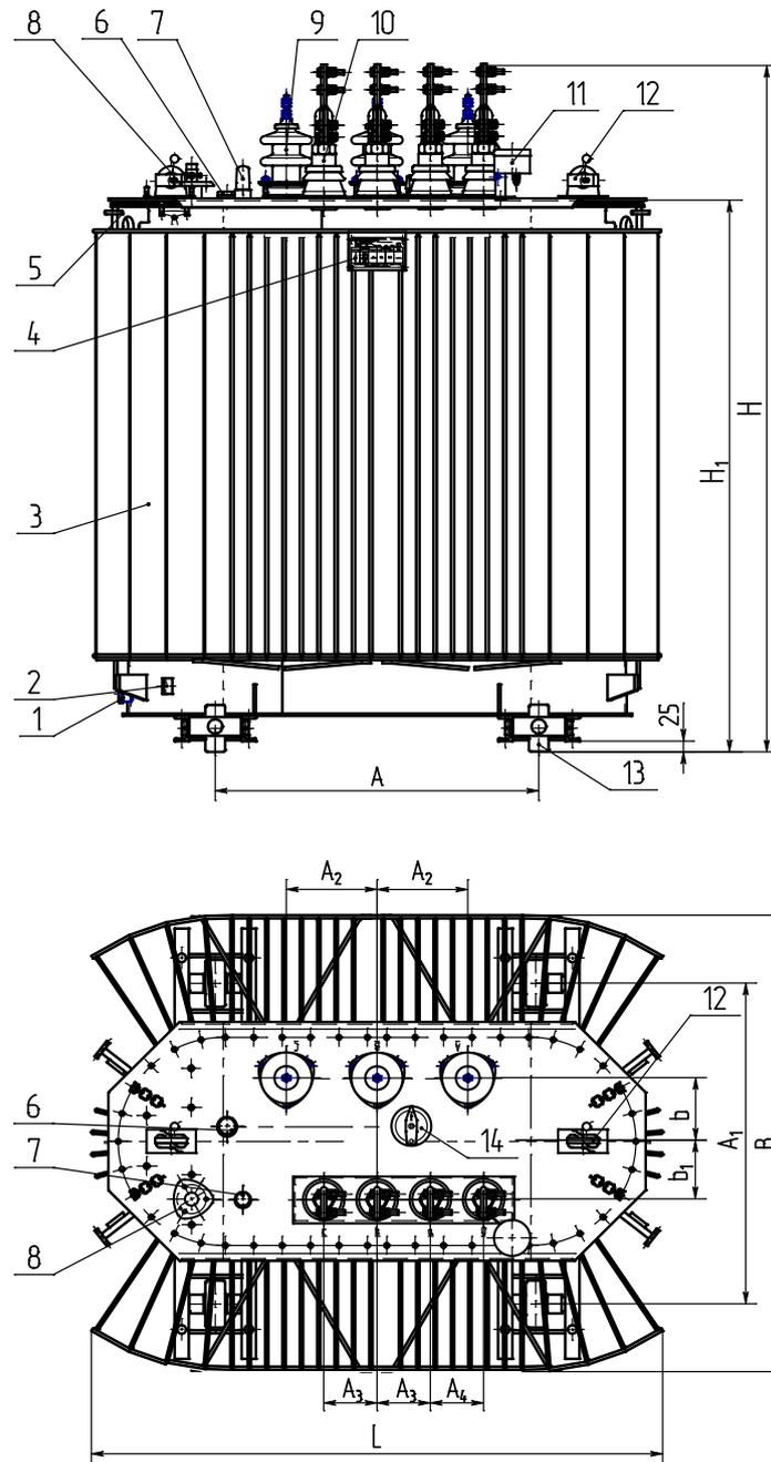
1 - пробка сливная; 2 - зажим заземления; 3 - бак; 4 - табличка; 5 - серьга для подъема трансформатора; 6 - гильза для термометра; 7 - маслоуказатель; 8 - патрубок для заливки масла; 9 - ввод ВН; 10 - ввод НН; 11 - пробивной предохранитель (устанавливается по заказу потребителя); 12 - серьга для подъема активной части с крышкой трансформатора; 13 - ролик транспортный; 14 - переключатель.
