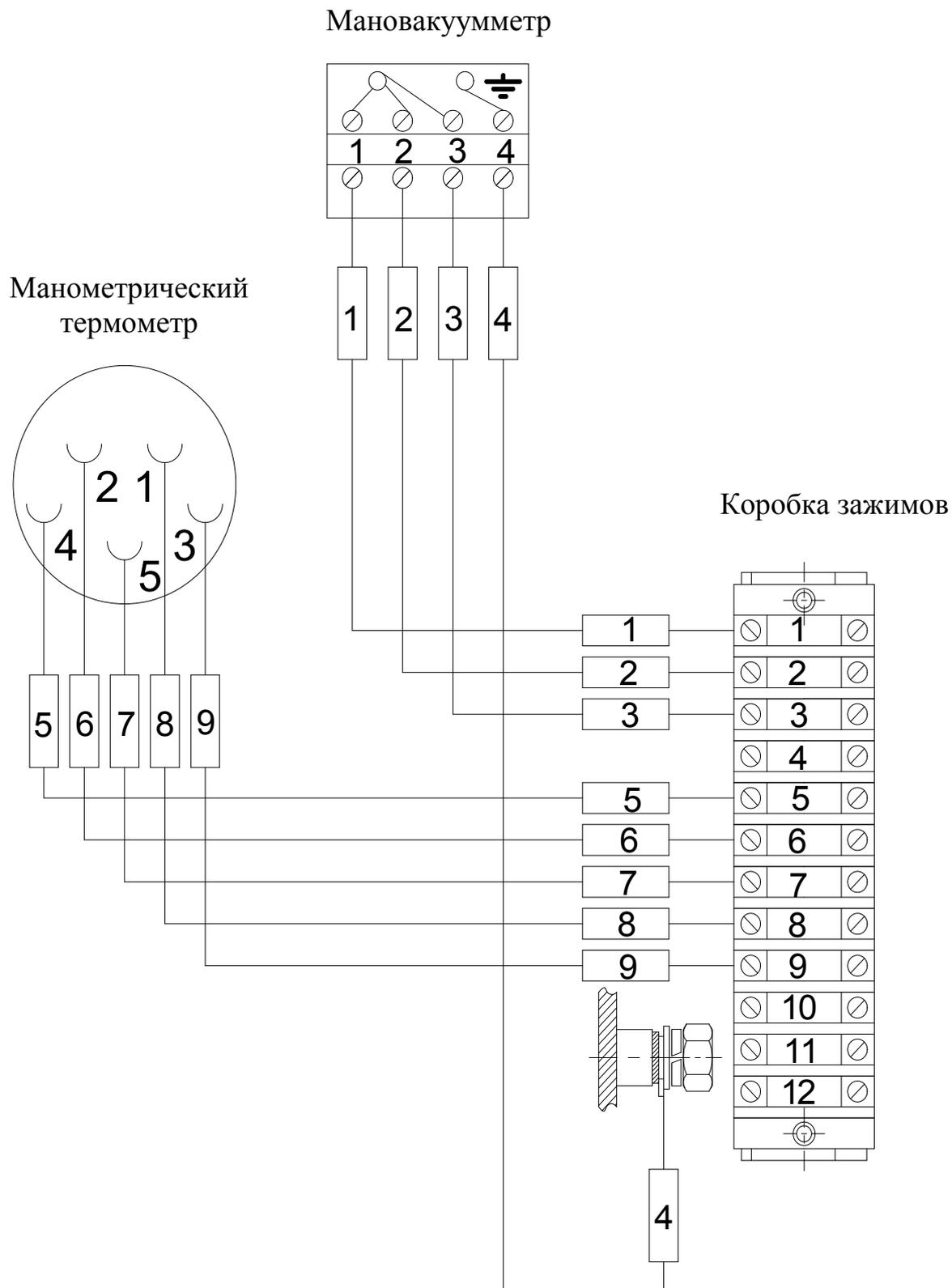
Рисунок А.22 – Монтажная схема соединения коробки зажимов с контрольно-измерительными приборами
