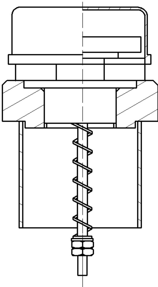
Рисунок А.15 – Предохранительный клапан сброса давления
