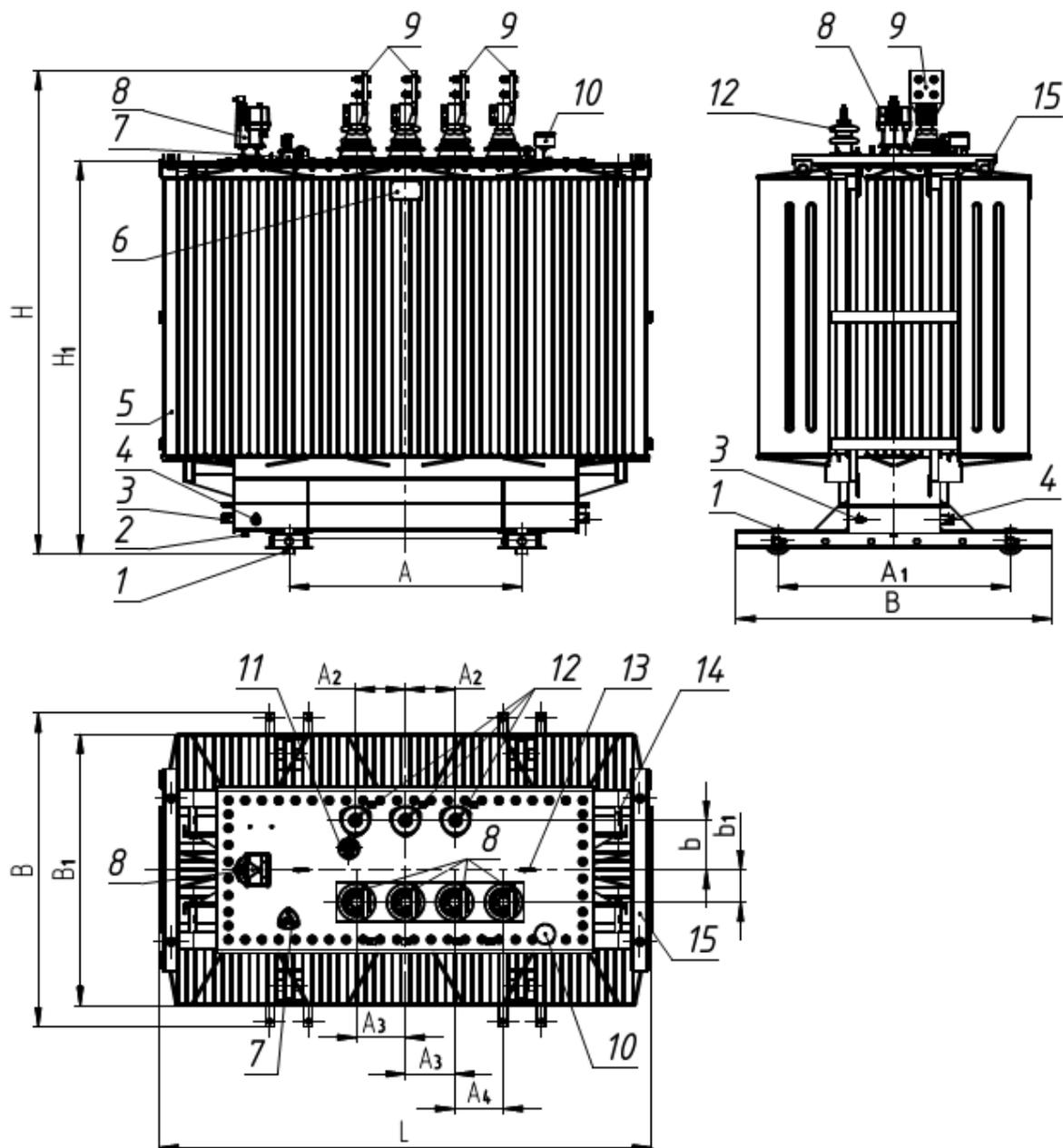
1 - ролик транспортный; 2 - пробка для удаления продуктов окисления и остатков масла; 3 - зажим заземления; 4 - пробка для слива масла; 5 - бак; 6 - табличка; 7 - патрубок для заливки масла; 8 - реле защитное; 9 - ввод НН; 10 - пробивной предохранитель (устанавливается по заказу потребителя); 11 - привод переключателя; 12 - ввод ВН; 13 - серьга для подъема крышки; 14 - узел для подъема трансформатора; 15 - узел для крепления трансформатора при транспортировании
